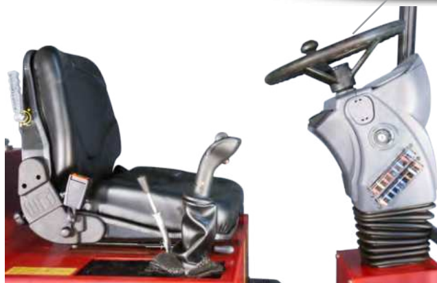
Einhebelbedienung & verstellbare Lenksäule
