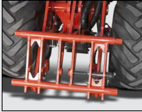
Thaler-Haken-Aufnahme Thaler hook bracket system
