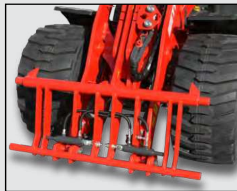
Euro-8-Aufnahme Euro Recoupling system
