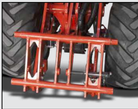
Thaler-Haken-Aufnahme Thaler hook bracket system
