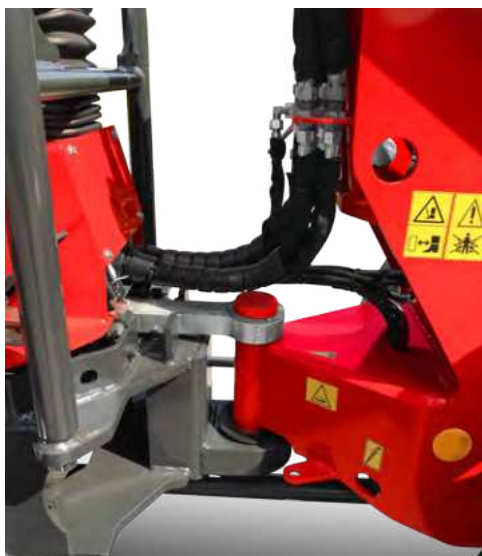
Robustes, wartungsarmes Knickpendelgelenk
