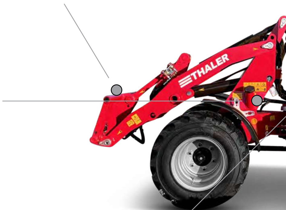
Robustes, wartungsarmes Knickpendelgelenk
