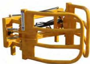
Ballenzange Hydraulic bale grabber
