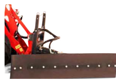
Futterschiebeschild Rubber scraper
