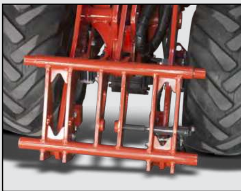
Thaler-Haken-Aufnahme Thaler hook bracket system
