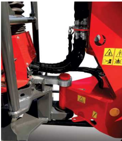
Robustes, wartungsarmes Knickpendelgelenk
