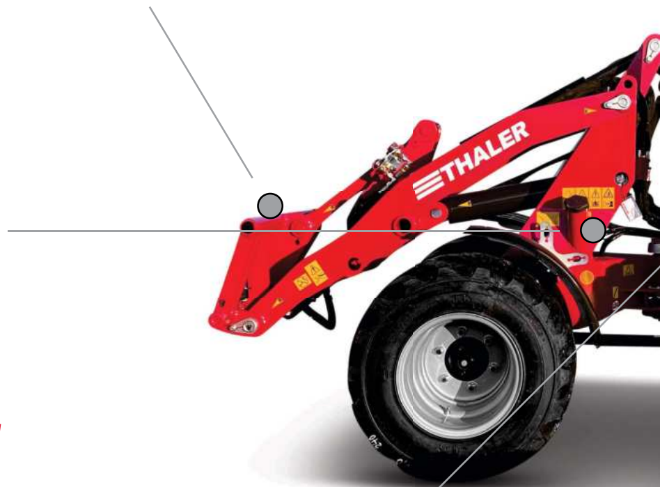
Robustes, wartungsarmes Knickpendelgelenk
