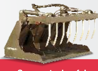
Sperrgutschaufel mit Aufsatz Bucket (open sides)+grabber
